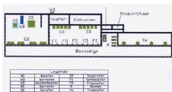
Abb. 4: Rekonstruktion der technischen Einrichtung der Saigerhütte in Agricolas „De re metallica“ in der Seminararbeit der Studierenden des IWTG.
