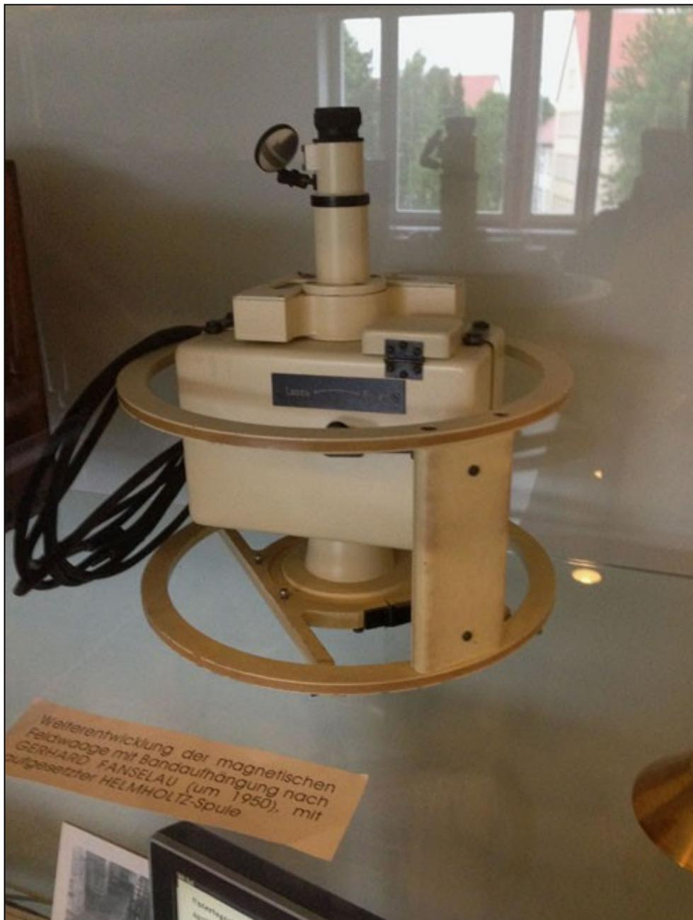
Eine ziemlich moderne Feldwaage nach G. Fanselau, um 1950. Das Gestell drumherum stellt eine Helmholtz- Spule dar, die zur Kalibrierung des Gerätes diente. Der oben am Okular gut sichtbare Spiegel lenkte Licht von außen in den Autokollimator, so daß keine Stromquelle für die Beleuchtung benötigt wurde, die die Messung vielleicht stören könnte.
