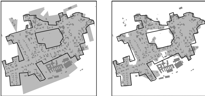
Abb. 2: Vergleich der ATKIS®-Ortslage (links) und der mittels ibTool generierten Innenfläche (rechts) (jeweils graue Fläche) gegenüber einer gutachterlich erzeugten Referenz (schwarze Linie) (Quelle: Harig 2014)
