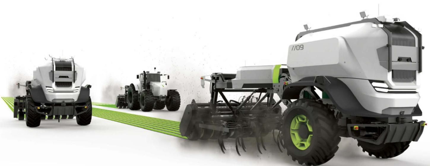
Der „Feldschwarm“ verkörpert die Vision eines modularen Systems semiautark operierender Anbaugeräte, die als Mehrmaschinenverbund in Kollaboration mit dem Systembediener geführt werden (Shared Autonomy)
