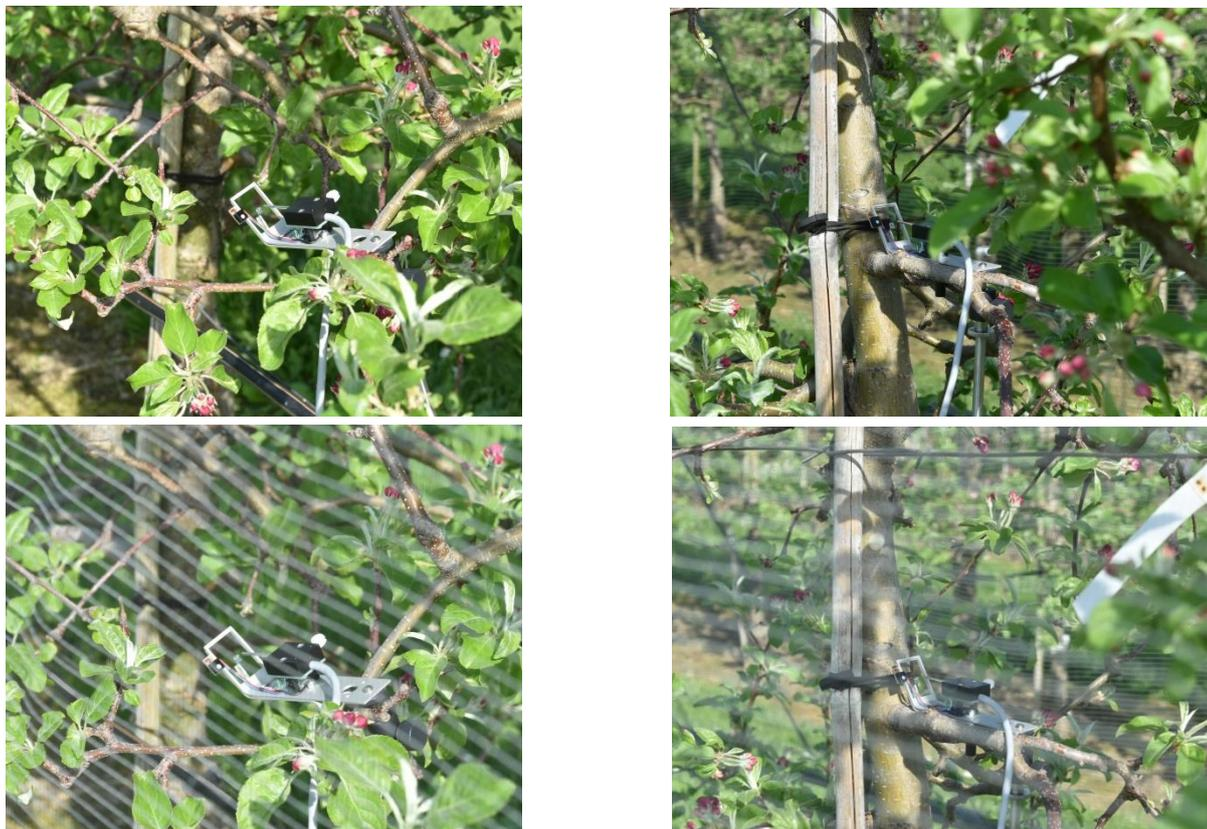
**Abbildung 3: Messung der photosynthetisch aktiven Strahlung mit und ohne Einnetzung; links: Messung in der Peripherie der Krone mit (unten) und ohne (oben) Einnetzung; rechts: Messung im Zentrum der Krone mit (unten) und ohne (oben) Einnetzung**
