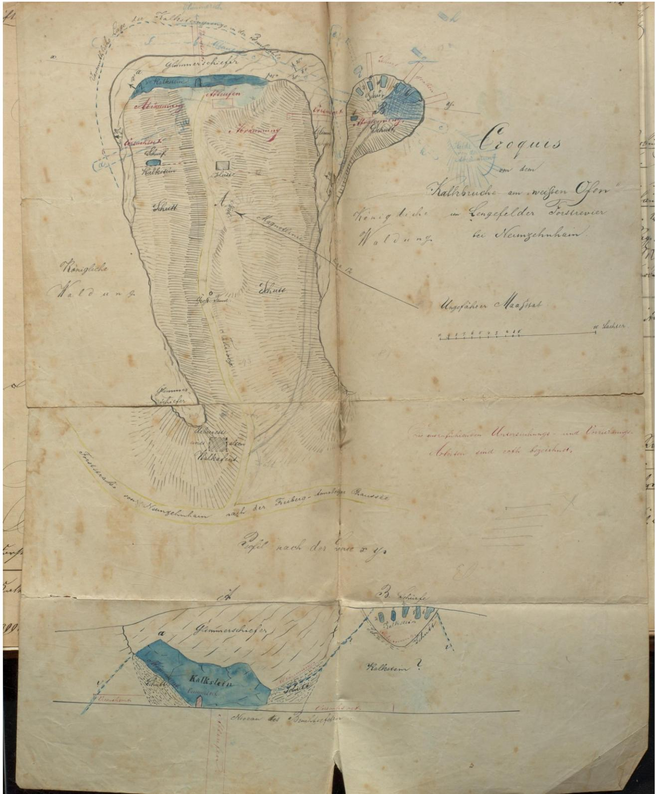
Für die Wiedererschließung des Steinbruchs hatte man bereits eine Croquis (Verleihkarte) skizziert, welche uns die damalige Aufschlussituation illustriert: oben Grundriß, unten Schnitt in Nord- Süd- Richtung; anstehender Kalkstein in der Bruchwand ist darin blau koloriert. Bildquelle: Sächsisches Staatsarchiv, Staatsarchiv Chemnitz, Bestand 30315 (Forstamt Marienberg), Archivnummer 82b, Blatt 227.
