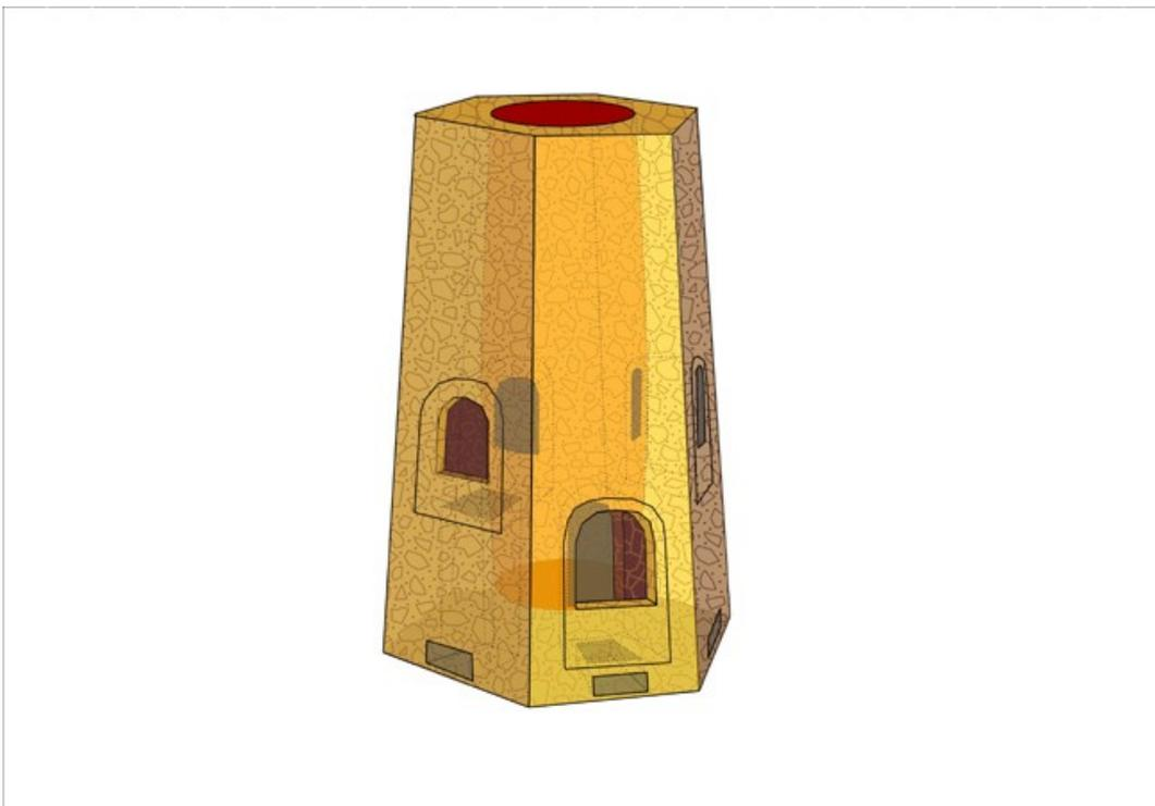
Besonderheit der Rüdersdorfer oder Rumford'schen Brennöfen sind die auf halbe Höhe und nach außen verlegten Feuerungen. Das Brennmaterial kommt dadurch nicht direkt mit dem Brenngut in Berührung und man kann reineren Branntkalk ohne Ascheanteile erzeugen. Dieser hier ist - wie bei weitem die meisten seiner Art - sechseckig symmetrisch gebaut.
