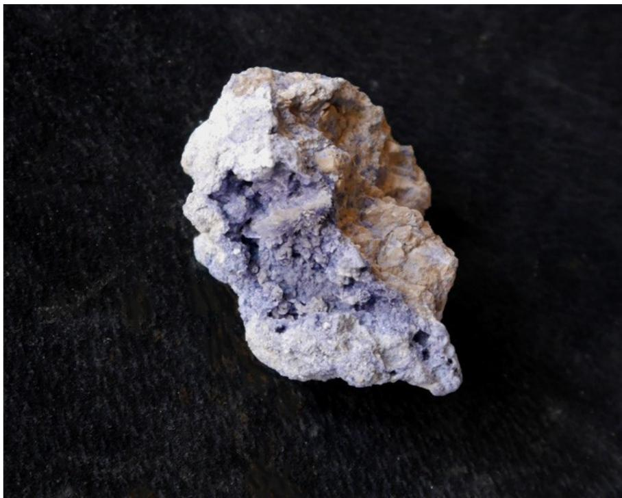
Ein seltener Beleg für sekundär gebildete, hier bläulich gefärbte Gips- Kriställchen aus Meerane. Diese Stufe stammt nicht aus dem Aufschluß in den Fotos oben; eine ähnliche Mineralisation könnte aber auch dort aufgetreten sein. Das Auftreten von Bleiglanz, Malachit und Kupferlasur im Plattendolomit wurde jedenfalls schon von den alten Geologen immer wieder erwähnt. Größe dieser Stufe zirka 4 cm x 3 cm. Sammlung M. Och, Meerane.
