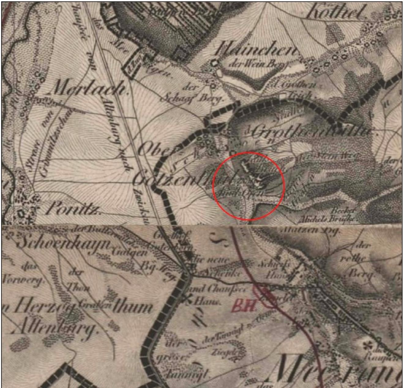
Auf der Oberreit'schen Karte von Sachsen, Section Borna (oben) und Section Zwickau (unten), entstanden zwischen 1830 und 1850, ist südlich von Crotenlaide ein erster Kalkofen eingezeichnet. Auf dem südlichen Blatt wurde bereits die geplante Eisenbahnlinie rot nachgetragen.
