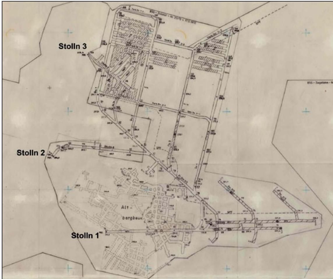
Ausschnittsvergrößerung aus obigem Riß. Im Süden ist das alte Baufeld der Königin Marien-Hütte zu sehen. Der neue Stolln 1 (unten) überfuhr diesen Altbergbau. Die recht systematische Aus- und Vorrichtung ist gut zu erkennen, auch der quasi abgebrochene Abbau. Nach Osten wurde das Bergwerksfeld übrigens durch ein Bergbauschutzgebiet für den Abbau von Ziegeleilehm begrenzt.
