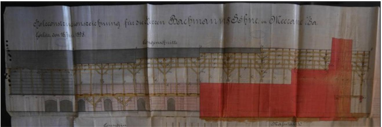
Ausschnitt aus obiger Bauzeichnung mit mehreren aneinandergfügten, vertikalen Längsschnittebenen. Ganz rechts ist der innenliegende Ofenkörper und der Schornsteinsockel dargestellt. Im Mittelteil sieht man die Außenansicht des Brennöfens mit den Toren zum Beschicken der Brennkammern, ganz links die Außenansicht der Umbauung mit den Trockenböden.
