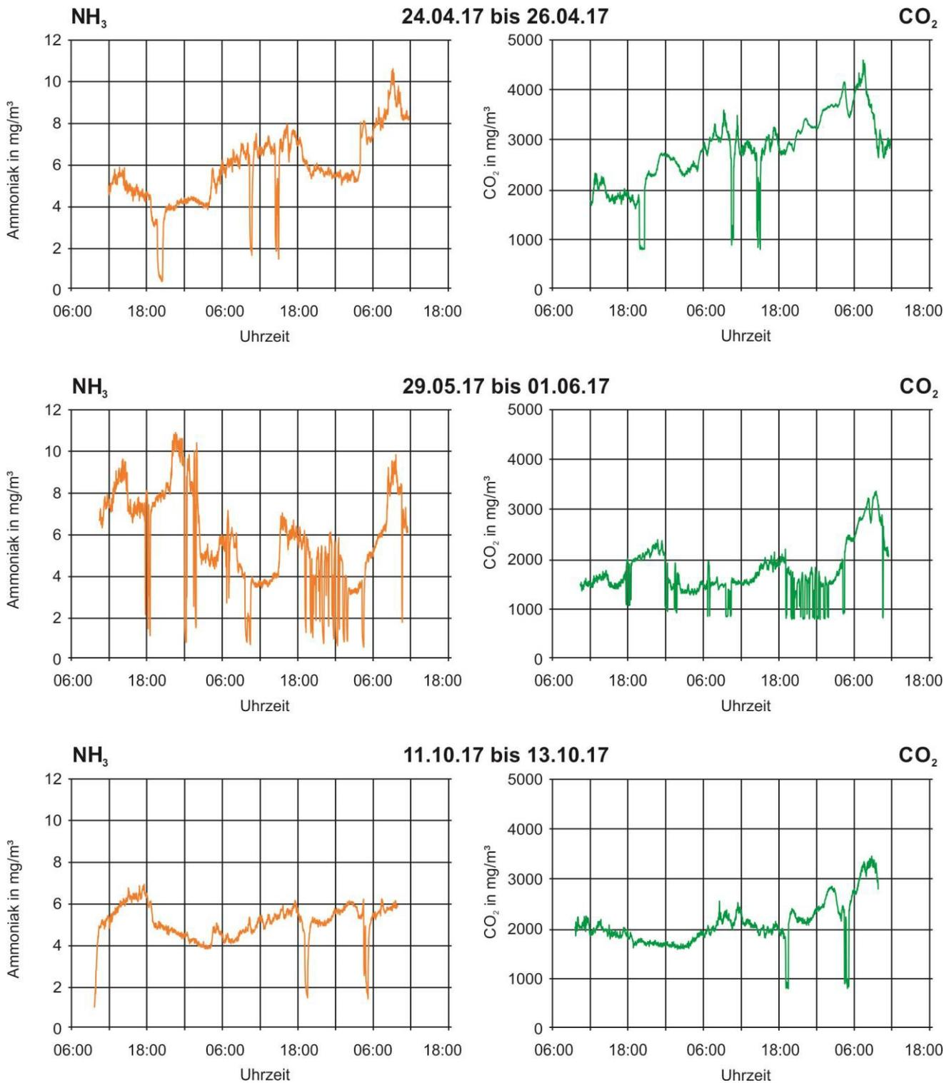
**Abbildung 10: Verlauf der Ammoniak- und CO<sub>2</sub>-Konzentrationen in der Emission von LH2 während der Messungen.**
