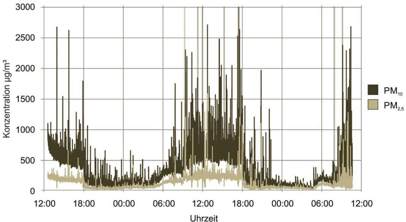
**Abbildung 16: Zeitlicher Verlauf der mit dem Aerosolspektrometer vom 19.06.2017 – 21.06.2017 kontinuierlich gemessene Staubkonzentrationen von PM<sub>10</sub> und PM<sub>2,5</sub> an LH1.**
