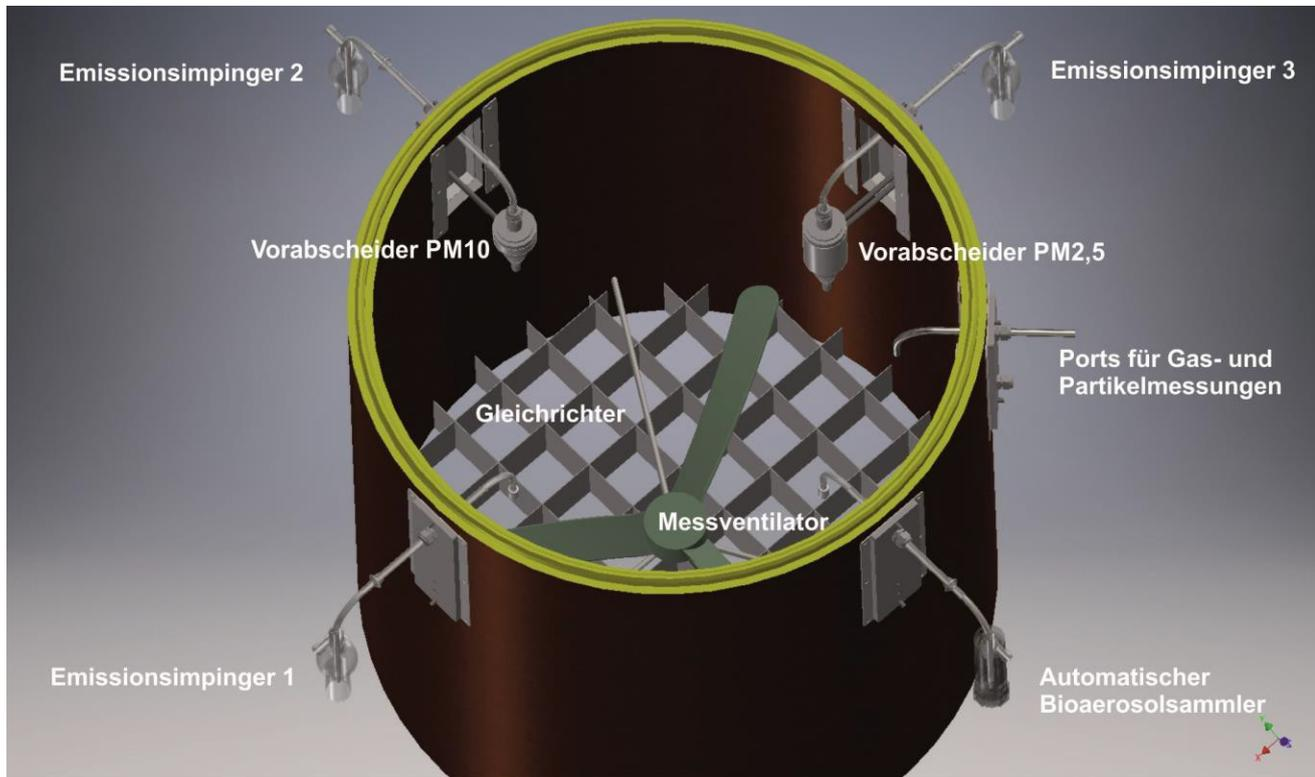
**Abbildung 4: Messmodul ausgerüstet mit den verschiedenen Probenmesystemen**
