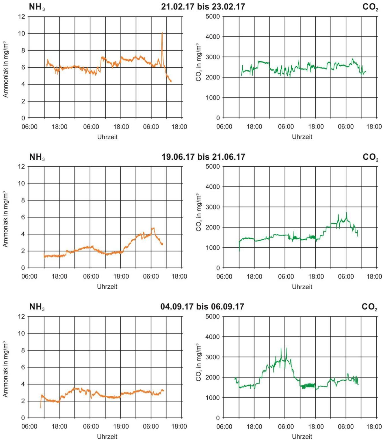
**Abbildung 7: Verlauf der Ammoniak- und CO<sub>2</sub>-Konzentrationen in der Emission von LH1 während der Messungen.**
