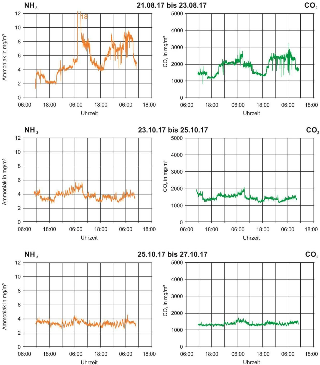
**Abbildung 13: Verlauf der NH<sub>3</sub>- und CO<sub>2</sub>-Konzentrationen in der Emission vom MP während der Messungen.**
