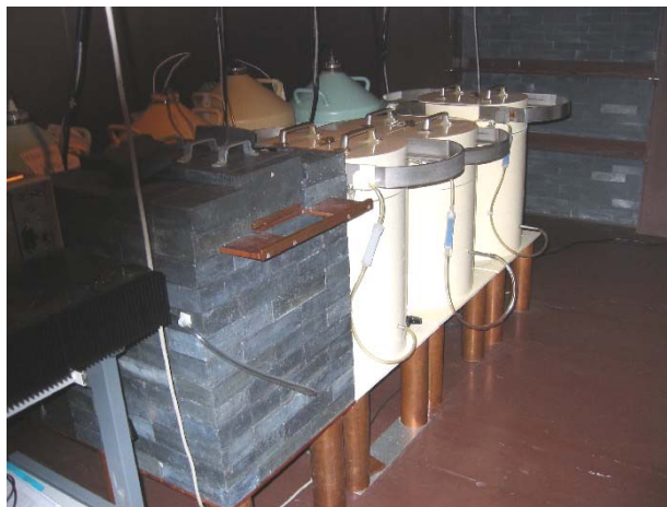
Abbildung 4: HPGe-Detektoren in Bleiabschirmungen in der Messkammer mit Wänden aus Stahl und Blei
