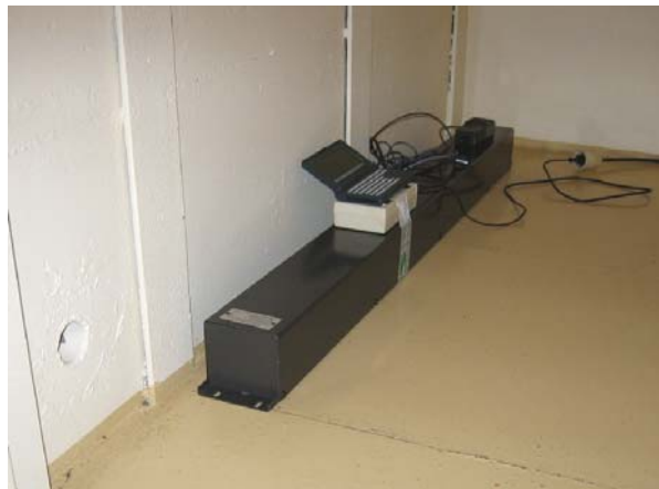
Abbildung 5: Neutronendetektor der Fa. GBS-Elektronik im Labyrinth der Messkammer mit der Abschirmung aus Serpentin
