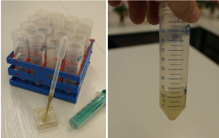
Abbildung 21: Geräte zum Abmessen und Verdünnen des Pflanzenpresssaftes und fertig verdünnter Presssaft von Poinsettien
