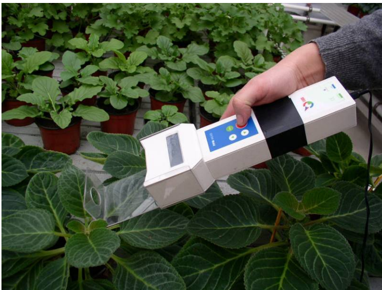
Abbildung 25: Messung der Chlorophyllfluoreszenz mit dem PPM-Messgerät der Firma EARS (Niederlande)
