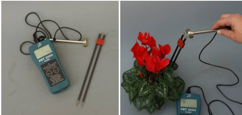
Abbildung 13: Einsatz von PE-KT-Sonden
