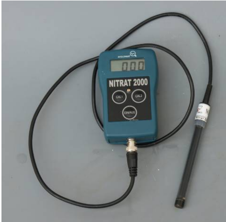
Abbildung 7: Messgerät Nitrat 2000 mit ionenselektiver Sonde
