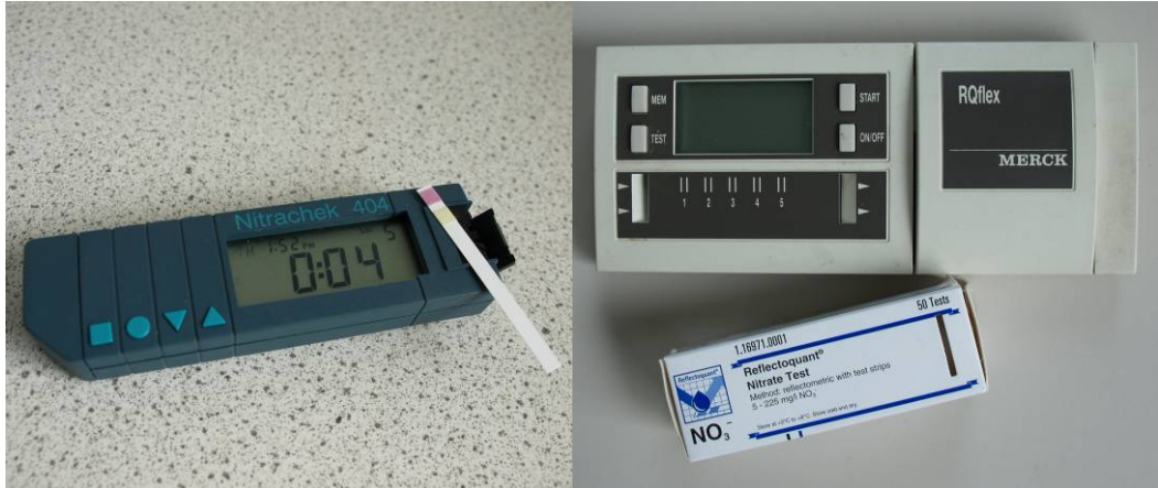
Abbildung 6: Reflektometer zur Nitratbestimmung Nitrachek 404 und RQflex ®
