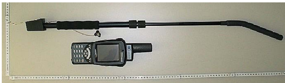
Abbildung 11: Stabantenne zu Gerät 7
