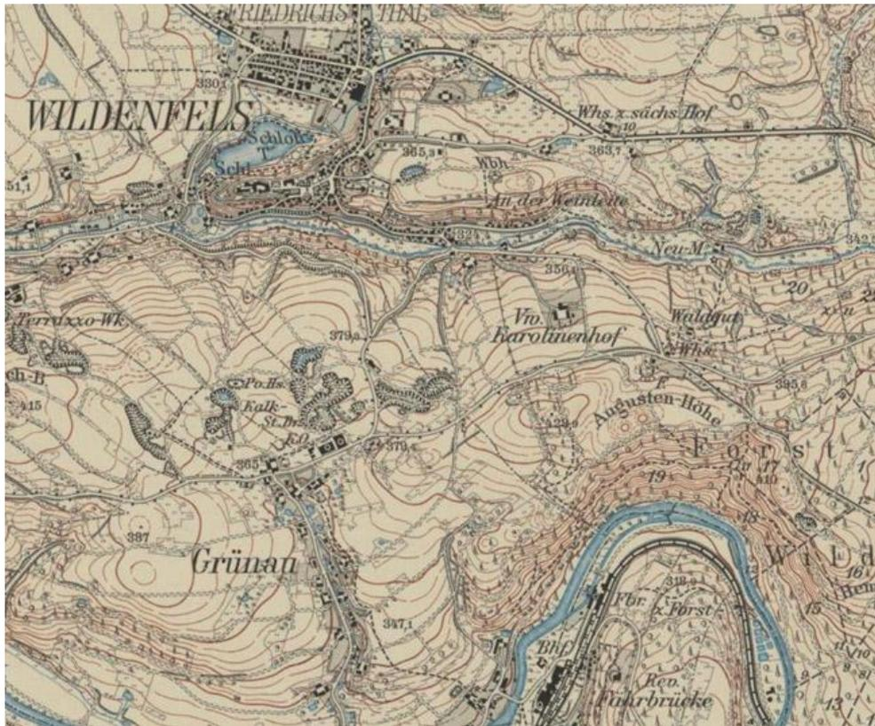
Gleiche Karte, weiter talaufwärts. Am Rande des früheren fiskalischen Schwarzen Bruches ist ein „Pulverhaus“ als Sprengmittellager entstanden. In Kalkgrün sind jetzt die beiden Ringbrandöfen und nördlich der Steinbrüche ist ein Pulverhaus (Pv.-Hs.) eingezeichnet.
