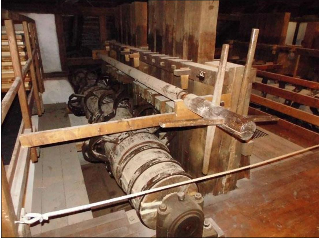
Die Daumenwellen sind im Niveau des Obergeschoß-Fußbodens montiert. Im Hintergrund sieht man die Dachunterseite der Radstuben - dort hätten eigentlich die Antriebsräder stehen müssen...
