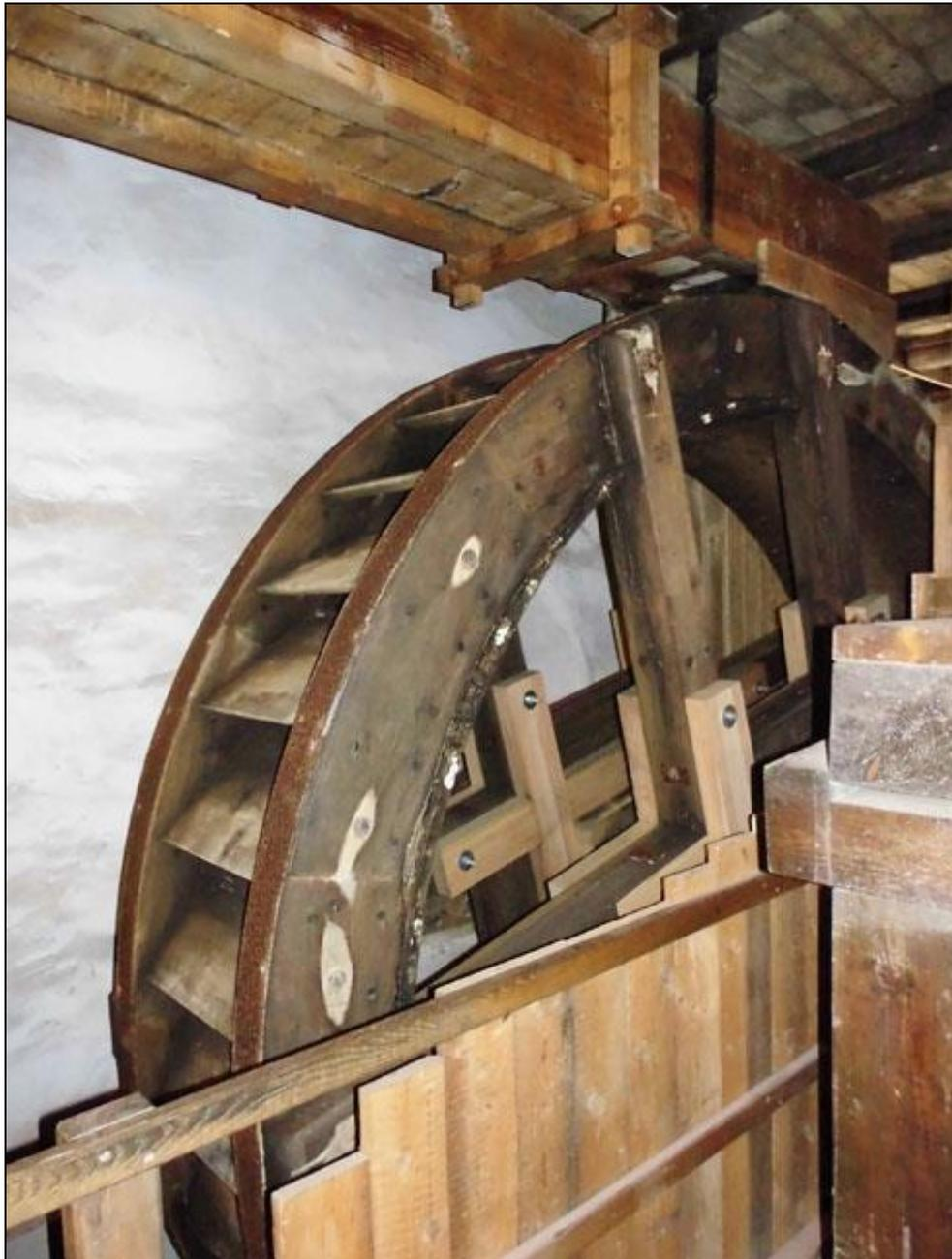
Dahinter zu deren Antrieb das einzige noch vorhandene und betriebsfähige Wasserrad.
