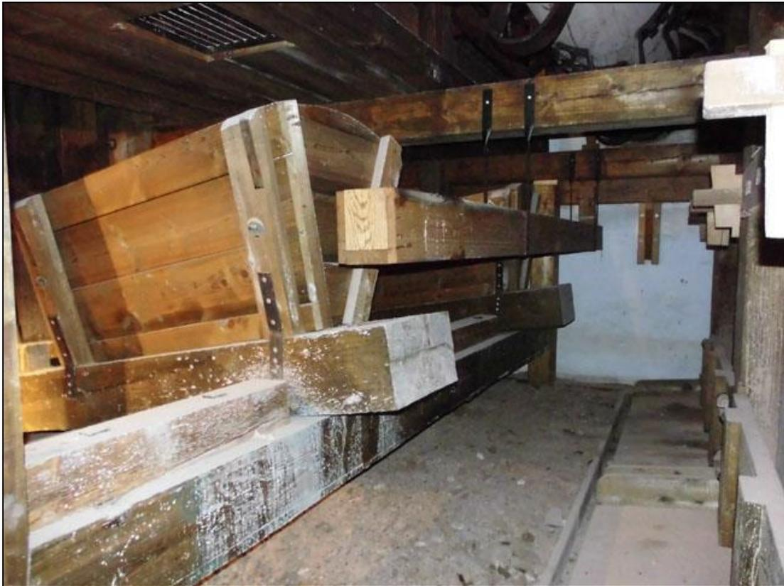
Hier der weitere Weg des Pochgutes: Durch die Roste fällt es zunächst in diese V-förmigen Vorratsbehälter. Mit Wasser aus der – im Bild quer dahinter aufgehängt sichtbaren – Holzrinne wurde es dann unter die Stempel gespült.
