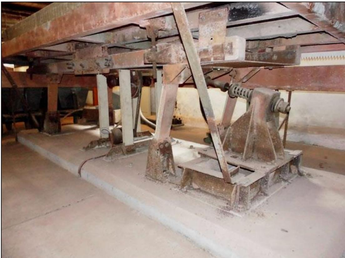
Der Antrieb erfolgte bereits elektromechanisch. Man muß sich aber schon mal unter den Herd knien, um diesen Antrieb zu entdecken. Gelagert sind die Herdtische auf Blattfedern.
