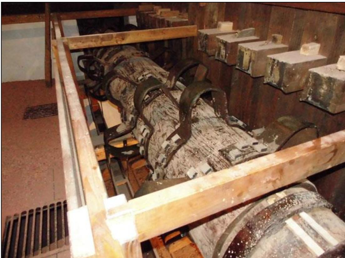
Die „Daumen“ auf den Antriebswellen sind aus Eisenbändern gefertigt. Bei jeder Umdrehung der Welle wurden die Stempel dreimal angehoben.
