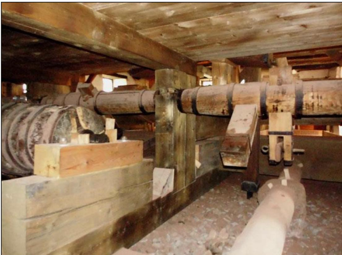
Die Radwelle schiebt über das Drückelzeug die Stoßherde an. Am vorderen kann man gut drunterschauen und die Mechanik des Drückelzeuges erkennen.
