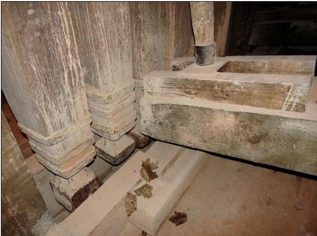
Von rechts im Bild die „Rollenschnauze“ des Vorratsbehälters. Weil die Pochschuhe von unten in die Stempel eingesetzt sind, werden die Stempel mit eisernen Bändern zusammengehalten, damit die Schläge das Holz nicht auseinandertreiben.
