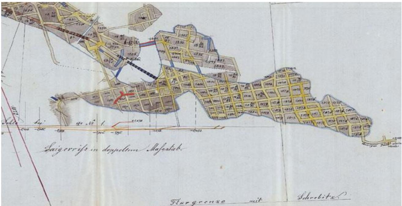
Ausschnitt aus obigem Grundriß mit dem südöstlich anschließenden Tiefbaufeld. Nach der Beschriftung der gelöschten Abbaublöcke begann der Tiefbau - weit entfernt vom Tagebau - um 1870 (im Bild der linke Teil dieses Baufeldes), erreichte etwa 1876 die südöstlichste Bauwürdigkeitsgrenze und wurde dann bis etwa 1889 in nördliche Richtung fortgesetzt. Der systematische Pfeilerbruchbau ist auffallend und wirkt äußerst modern.
