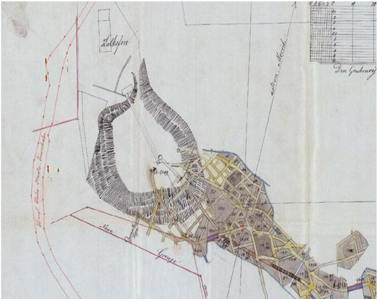
Ausschnitt aus obigem Grundriß mit dem Tagebau und dem daran angrenzenden Tiefbaufeld. Der Abbau in diesem Abschnitt schloß sich an das südöstliche Feld an, begann etwa 1885 und hatte sich rückschreitend bis 1900 dem Tagebau angenähert. Hier blau eingezeichnet: Bauwürdigkeitsgrenze (Ton angetroffen), rot nachgetragen die Schmalspurbahnlinie. Die Eintragungen des Förderbergs, der Haspel und des Kalkofens sind leider nur schematisch.
